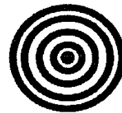
6. ábra. Michelson-féle interferométerrel létrehozott interferenciakép
