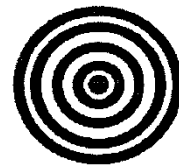
6. ábra. Michelson-féle interferométerrel létrehozott interferenciakép
