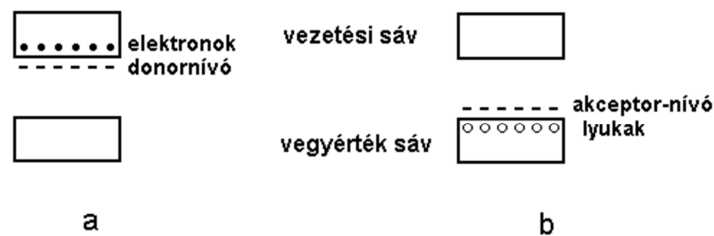
4.B.2. ábra. a: n-típusú, b: p-típusú félvezető sáv szerkezete
