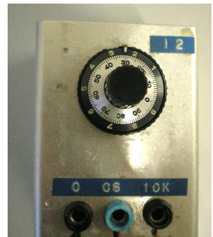
11. ábra: A mikrodiál 230-ra állítva
