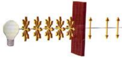
5. ábra: Lineárisan polarizált fény előállítása polarizátorral. forrás: http://www.vilaglex.hu/Lexikon/Html/Polariza_.htm
