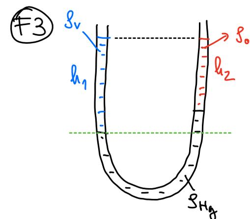
A rendszer egyensúlyban van, ezért a zöld vonallal jelzett magasságban a két szárnban oronos a nyomás:
