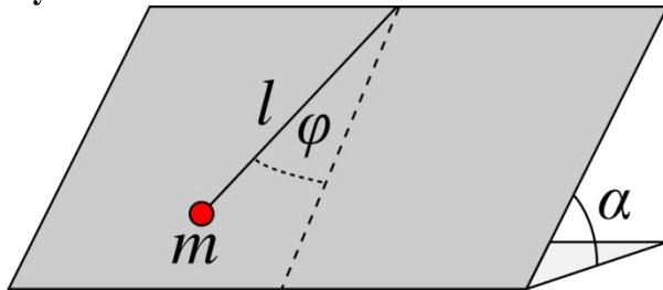
Egy állítható  $\alpha$  hajlásszögű lejtőre egy  $m$  tömegű  $l$  hosszúságú matematikai ingát fektettünk. Az inga kitérését a  $\varphi$  szöggel mérjük. Az ingatest súrlódás nélkül mozoghat a lejtőn.
