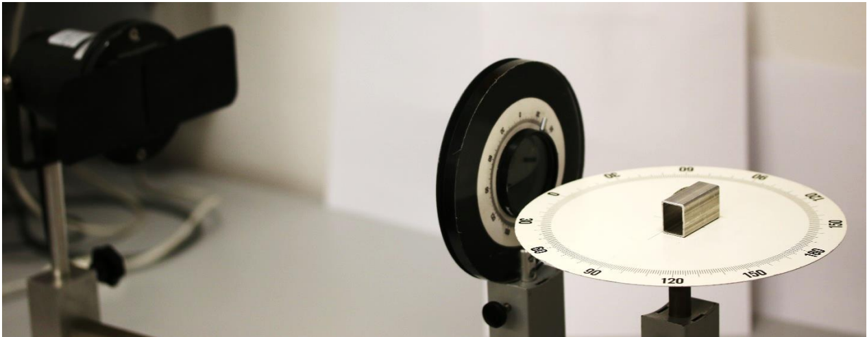
24. ábra: Lámpa réssel; közös lovason a diartartóba csúsztathatóan elhelyezett rés és a polarizátor; a forgatható korongra helyezett ismeretlen törésmutatójú anyag.
